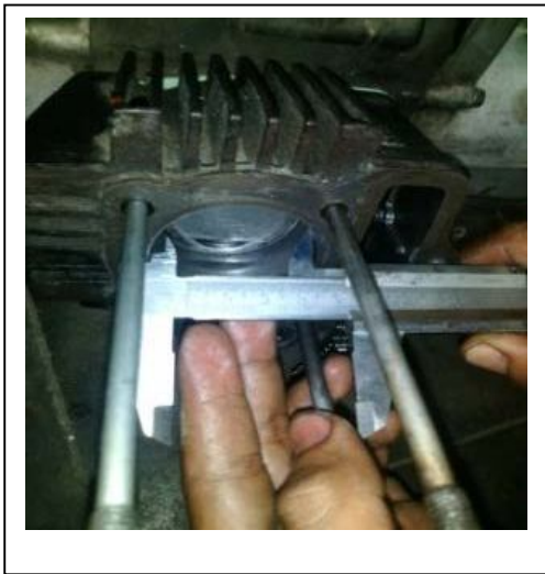
Gambar 8. Pengukuran diameter selinder
