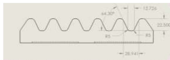
Gambar 4. Gambar Perencanaan Pola Jaw Plate
