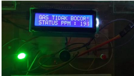
Gambar 8. Pengujian Lampu LED Hijau
