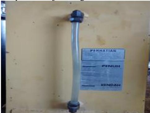
Gambar 19. Pengecekan Level Reservoir Tank
