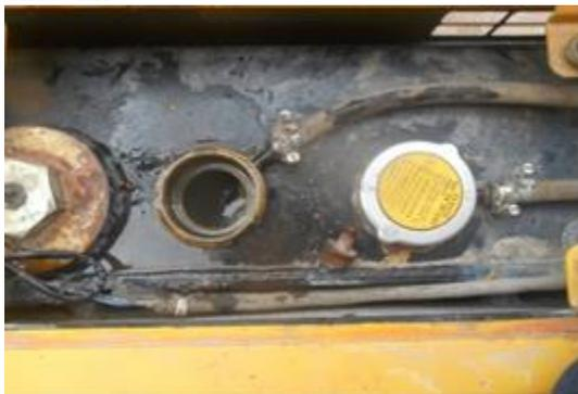
Gambar 20. Pengecekan Coolant di Radiator
