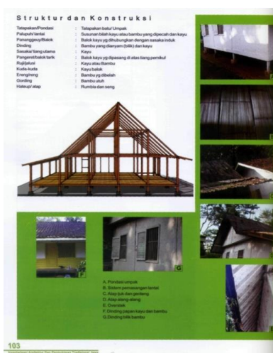
Gambar 4. Struktur dan Konstruksi Rumah Tradisional Bekasi
