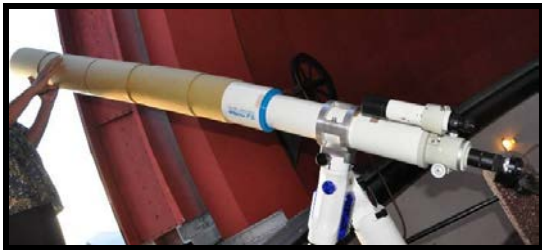
Gambar 13 Baffle yang digunakan oleh Dhani Herdiwijaya dan rekan (sumber : Herdiwijaya dkk. 2010)
