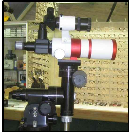
Gambar 15 (atas) Perpaduan teleskop WO Zenith Star 71 ED dengan kamera CCD SkyrS 274M dan filter infra merah, (bawah) teleskop yang dipasangkan di mounting (sumber : Thierry Legault)
