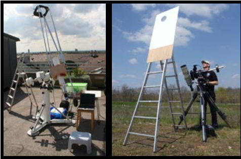
Gambar 12 (kiri) Baffle yang digunakan oleh Martin Elsasser (sumber : www.mondatlas.de ); (kanan) Baffle yang digunakan Thierry Legault (sumber : http://www.astrophoto.fr )
