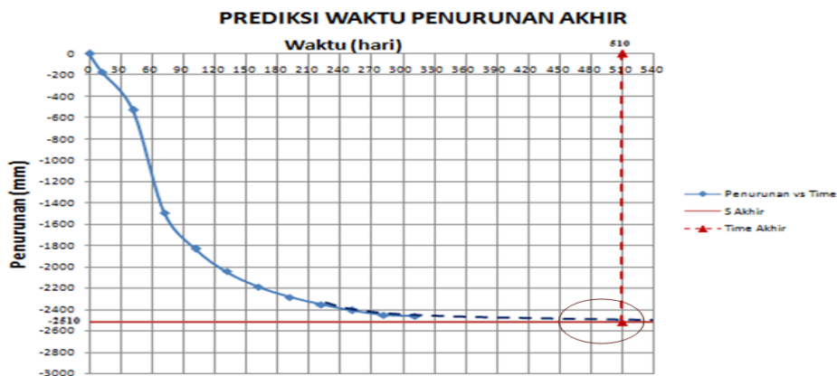
Gambar 10. Prediksi Tinggi dan Waktu Penurunan (Asaoka, 1978).
