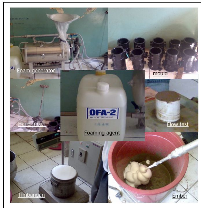
Gambar 2 Peralatan dan Bahan Percobaan Pencampuran Mortar Busa (Pusjatan, 2009)
