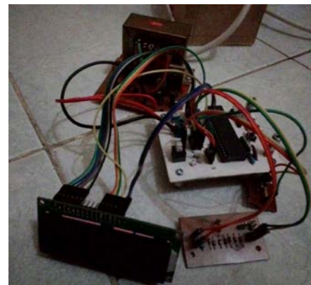
Gambar 10 Pengawatan pada sistem mikrokontroler ATmega32
