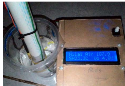
Gambar 13 Pengukuran kinerja sistem dengan contoh air mineral
