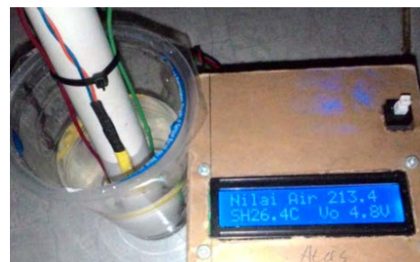
Gambar 17 Pengukuran kinerja sistem dengan contoh air bersifat asam
