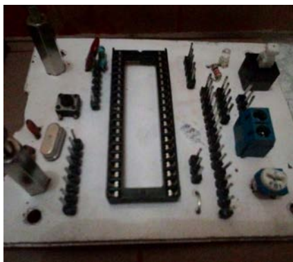
Gambar 8 Pembutan board untuk sistem mikrokontroler ATmega32
