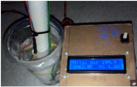
Gambar 14 Pengukuran kinerja sistem dengan contoh air mineral yang dipanaskan
