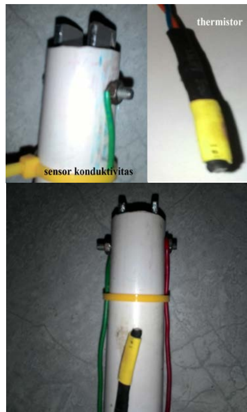
Gambar 4 Bentuk fisis sensor konduktivitas dan thermistor
