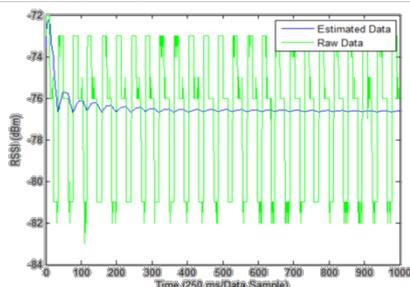
Gambar 1. Grafik proses Kalman Filter pada RSSI
