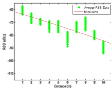
Gambar 3. Average data RSSI dari sampel pengukuran
