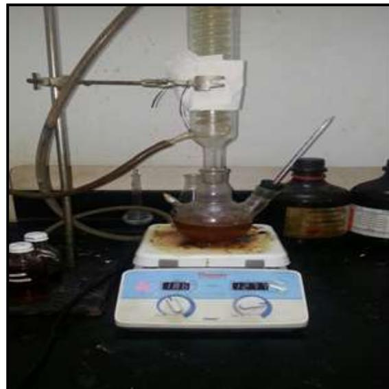
Gambar 6. Foto reaktor sintesis biodiesel
