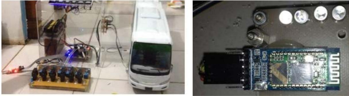
Gambar 3 Sistem minimal berbasis mikrokontroler, miniatur otobis, dan modul *bluetooth* HC-05
