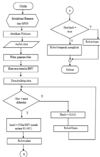
Gambar 3. Flowchart Robot Mobil Pengikut Manusia
