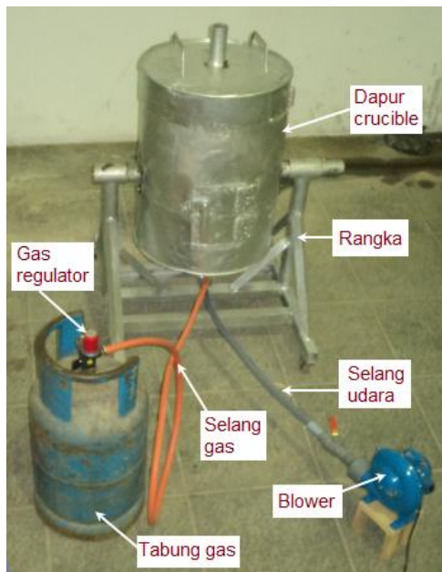
Gambar 2. Dapur crucible hasil rancangan
