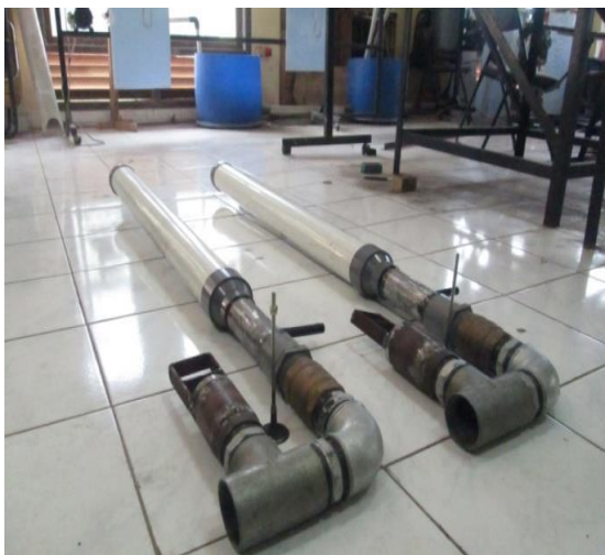
Gambar 5. Hasil pembuatan dan perakitan pompa hydraulic ram pump
