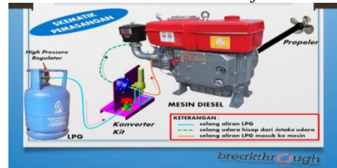
Gambar 6. Skema kerja sistem dual-fuel .
