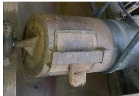
Gambar 3. Pengambilan emas dengan Proses Amalgamisasi
