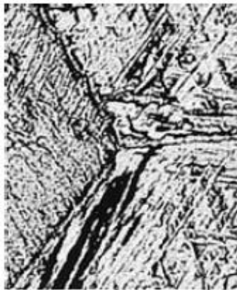
Gambar 3. Struktur mikro dengan phase Acicular \alpha+\beta , prior beta grain boundaries. Etchant: 10 HF, 5 HNO 3 , 85 H 2 O. 250X [5].
