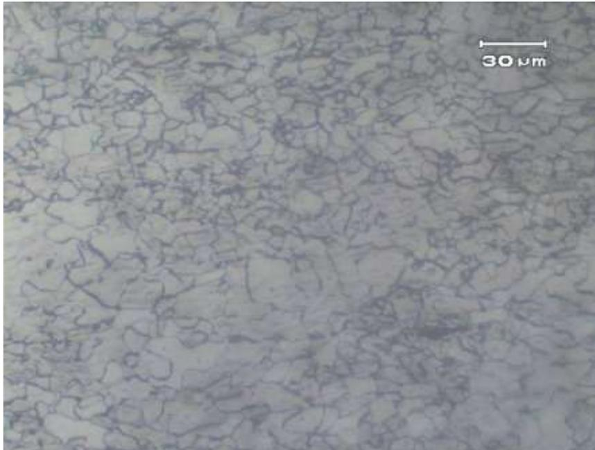
**Gambar 7.** Struktur mikro baja laterit hasil pengerolan panas dengan reduksi 30-35%. Pembesaran 500x. Etsa Nital 2%
