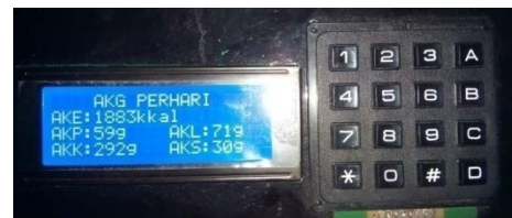
Gambar. 4.6 Tampilan Output Hasil Pengukuran AKG
