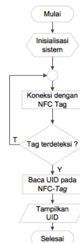
Gambar 8. Flowchart Pembacaan NFC-Tag
