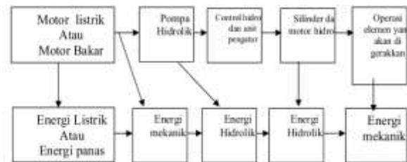
Gambar 1. Diagram aliran sistem hidrolik
