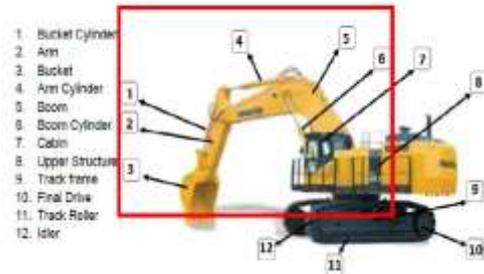
Gambar 4. Komponen silinder dari *Hydraulic Excavator 1250-7*
