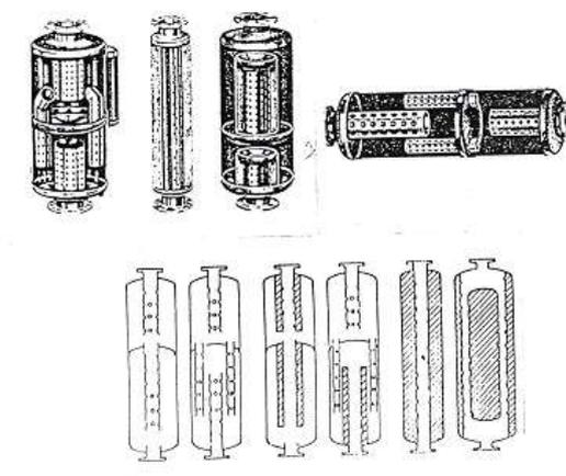
Gambar 2. Bentuk desain Muffler mesin diesel
