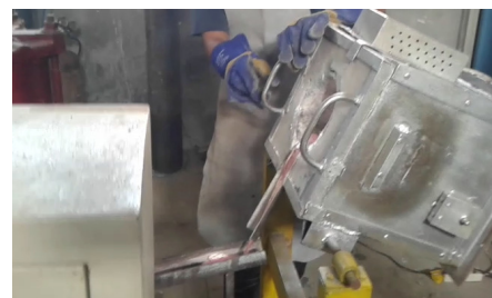
Gambar 8. Proses penuangan material coran.
