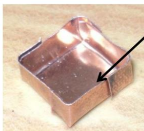
Gambar 4. Cetakan Piezoelektrik Dengan ukuran 1 x 1 x 0.5 cm 3
