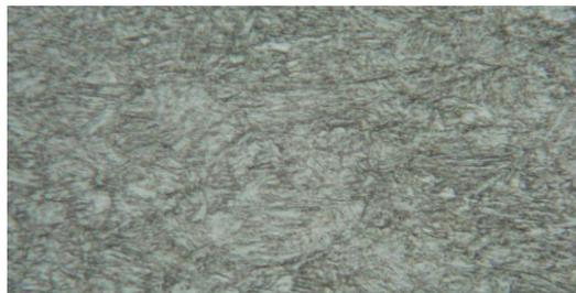
Gambar Foto Struktur Mikro Tanpa Perlakuan Panas, Pembesaran 1000X
