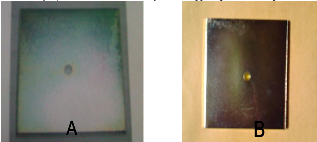
Gambar 2.1 Plat A : plat sebelum uji korosi, Plat B : plat setelah Salt Spray dengan variasi Non Heat Treatment
