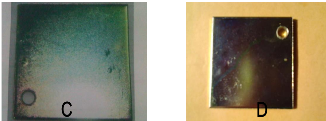
Gambar 2.2 Plat C : plat sebelum uji korosi, Plat D : plat setelah Salt Spray dengan variasi Heat Treatment dengan Quenching Air
