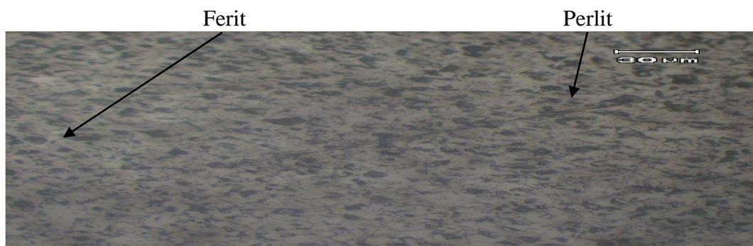
Gambar 2.14. Struktur mikro pada logam induk A pada spesimen yang di *annealing*
