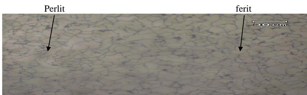
Gambar 2.22. Struktur mikro daerah logam induk B yang di *annealing*
