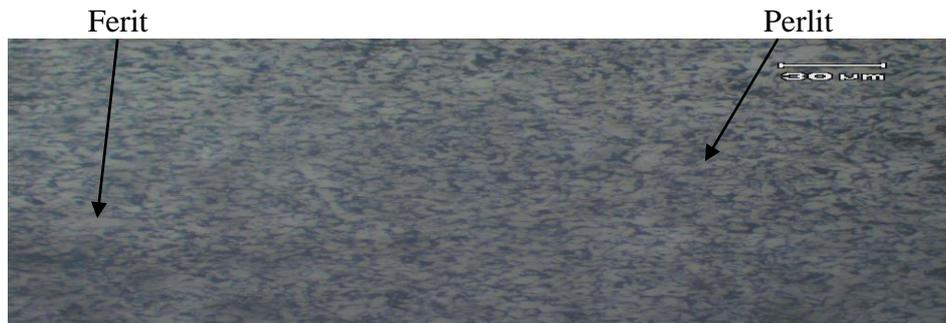
Gambar 2.13. Struktur mikro pada logam induk A pada spesimen tanpa mengalami perlakuan panas
