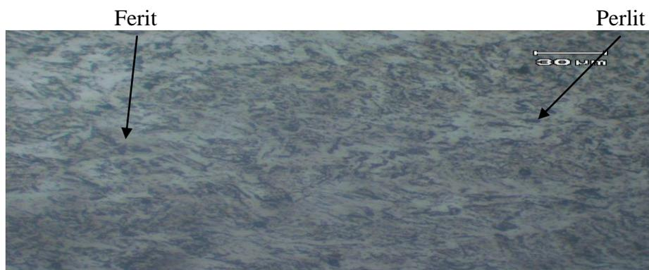
Gambar 2.17. Struktur mikro daerah lasan spesimen yang tanpa perlakuan panas
