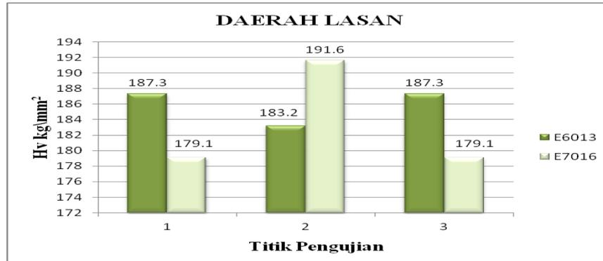
Gambar 2.6 Nilai Kekerasan Pada Daerah Lasan Posisi C
