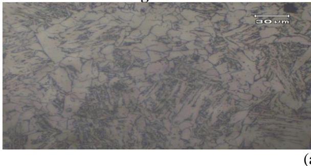
Gambar 2.10 Foto Struktur Mikro Daerah Lasan C
