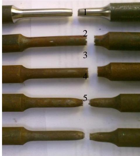
Gambar 2.1 Spesimen yang telah di uji tarik
