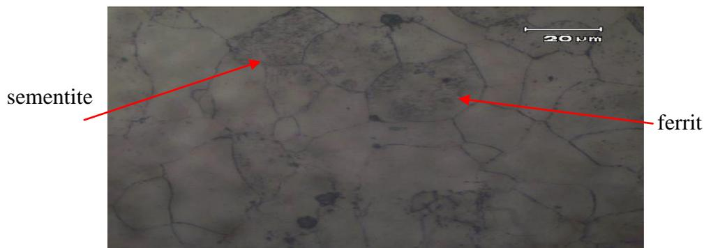
Gambar 2.6 Foto stuktur mikro Spesimen 4 pemanasan pada temperatur 850 °C,  *Holding time* 45 menit,  *Quenching* oli, dilanjutkan dengan proses temper pada temperatur 600 °C fasa ferrit dan fasa sementite etsa nital 2%
