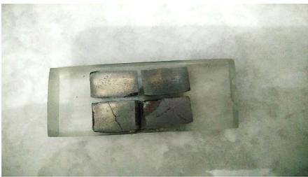
Gambar 4. Spesimen kekerasan *vickers*
