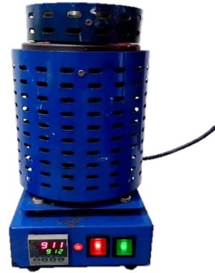
Gambar 6. Proses pemanasan spesimen pada temperatur 912°C
