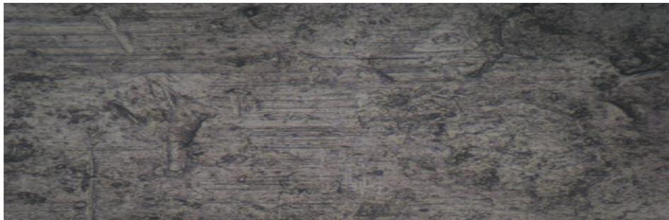
Gambar 2.8. Struktur makro pada almen strip A (200x) pada spesimen *shot peening 2 cycle*
