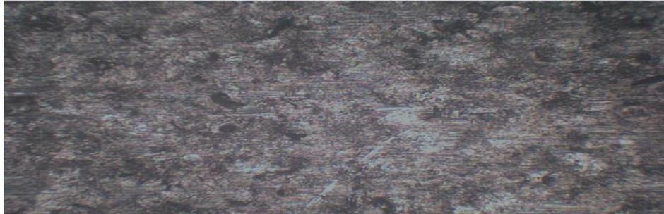
Gambar 2.10. Struktur makro pada almen strip A (50x) pada spesimen *shot peening* 4 *cycle*
