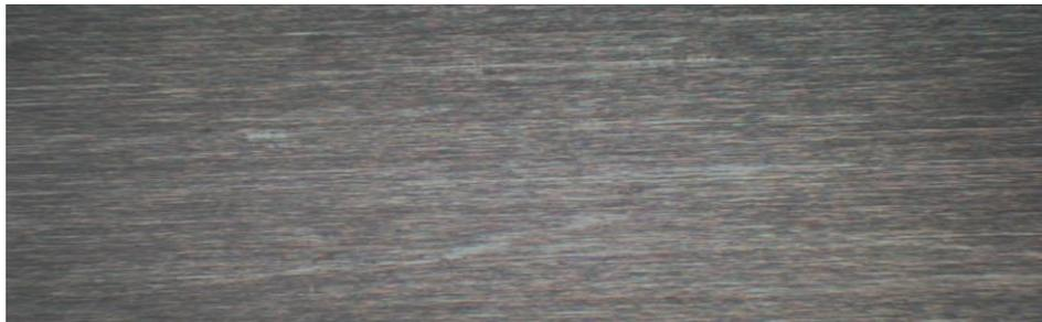
Gambar 2.5. Struktur makro pada almen strip A (500x) pada spesimen sebelum di *shot peening*
