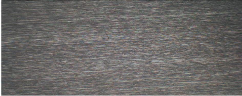
Gambar 2.3. Struktur makro pada almen strip A (100x) pada spesimen sebelum di *shot peening*
