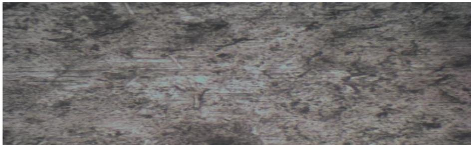
Gambar 2.7. Struktur makro pada almen strip A (100x) pada spesimen *shot peening 2 cycle*
