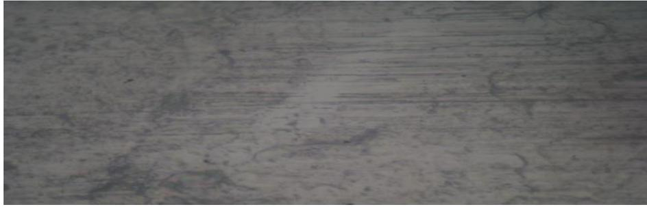
Gambar 2.13. Struktur makro pada almen strip A (500x) pada spesimen *shot peening* 4 cycle
