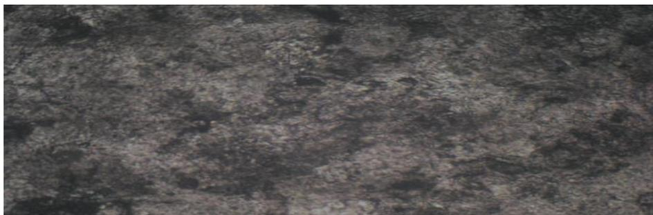
Gambar 2.15. Struktur makro pada almen strip A (100x) pada spesimen *shot peening* 8 cycle
