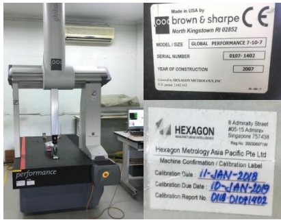
Gambar 5. Mesin CMM yang dipakai
