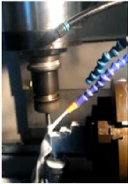
Gambar 13. Proses pembuatan hardjaw di mesin CNC.
