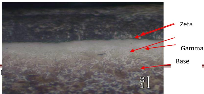
Gambar 2.9 Foto Struktur Mikro Lapisan Sampel 3
