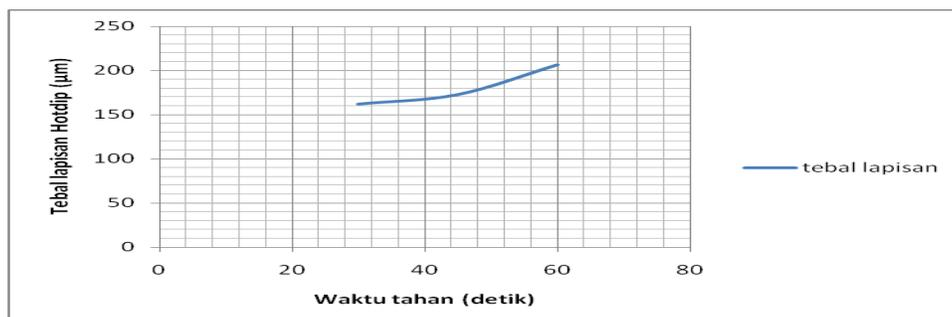
Gambar 2.2 Grafik Antara Ketebalan lapisan Hotdip dengan variasi Waktu tahan
