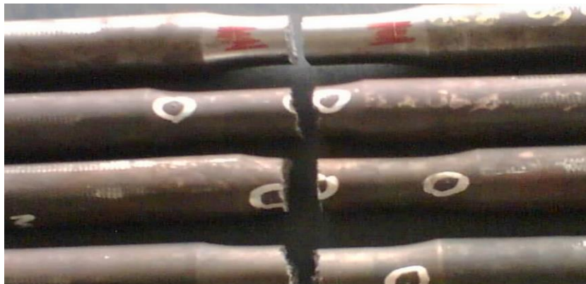
Gambar 2.1 Spesimen yang telah diuji tarik
