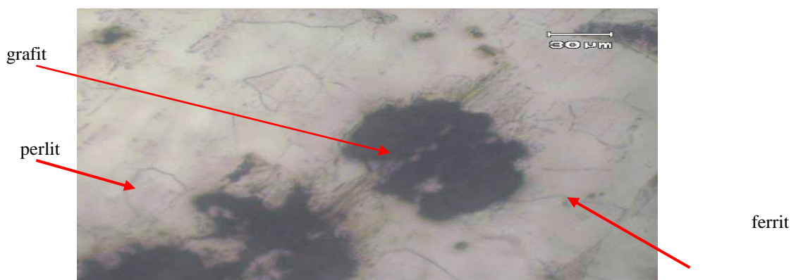
Gambar 2.3 Foto struktur mikro spesimen 1, grafit nodular dengan matrik perlit dan ferit etsa nital 3 %
