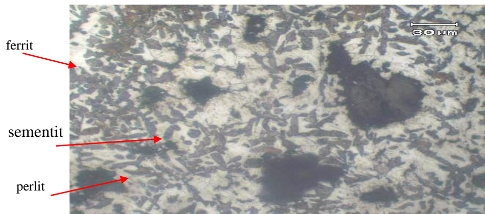
Gambar 2.5 Foto stuktur mikro spesimen 3, fasa perlit, sementit dan ferrit, etsa nital 3 %
