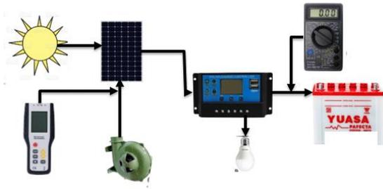
**Gambar 1.** Rangkaian percobaan pendingin panel surya menggunakan udara
