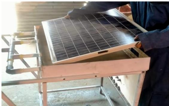
**Gambar 2.** Ukuran panel surya yang dilengkapi saluran udara pendingin
