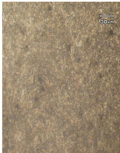
Gambar 4.7 Foto struktur mikro spesimen 5, fasa martensite temper etsa nital 2%
