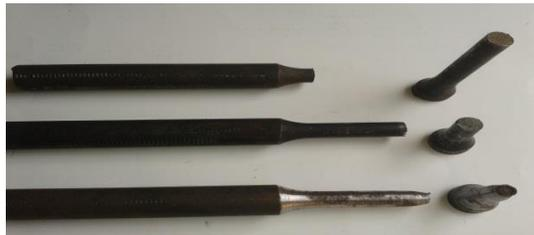
Gambar 4.1 Spesimen yang telah diuji tarik
