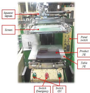
*Jig* dudukan benda kerja yang digunakan proses printing, setiap perubahan posisi *printing* karakter harus melakukan setting ulang dengan memutar *shaft* secara manual.
