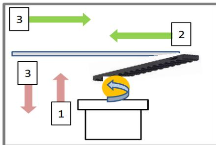
Agar benda kerja berputar maka merubah gerakan dari gerak lurus(horizontal) menjadi berputar dengan menggunakan cara kerja *rack gear* dan *spur gear*. Komponen tambahan yang dimaksud adalah *rack gear*, *spur gear*, *bearing*, dan *shaft*
