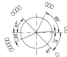
Berdasarkan dimensi pada gambar 2D produk, di ketahui diameter luar dan sudut antara tiap posisi cetakan/printing, sehingga dapat di hitung jarak tiap posisi cetakan/ printing pada permukaan bidang datar. Bidang datar yang dimaksud adalah permukaan *screen*. Berikut perhitungan bentangan dari permukaan silinder menjadi bidang datar:
