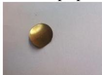
Gambar 26. Cacat pada produk blank
