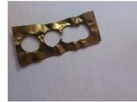
Gambar 4.41. Cacat pada *scrap*
