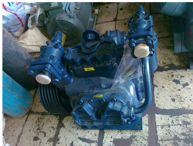
Gambar 4. Kompresor Dorin Type 2Q-80VS
