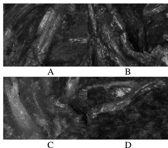
**Gambar 6.** Foto struktur mikro spesimen papan partikel dengan pembesaran 50X
