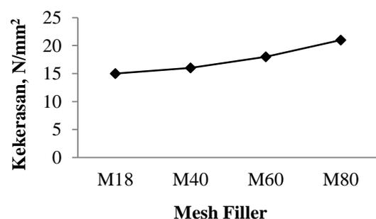
**Gambar 2** Pengaruh mesh filler terhadap kekerasan papan partikel
