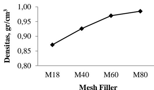
**Gambar 1.** Hubungan mesh filler dan densitas papan partikel
