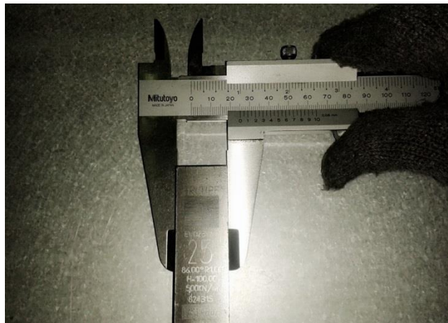
Gambar 4.1 Pengukuran dies sebelum modifikasi
