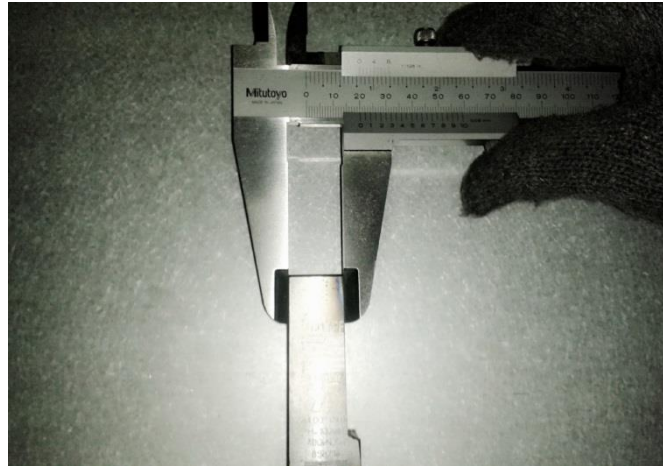
Gambar 4.2 Pengukuran Dies Sesudah Modifikasi
