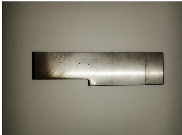
Gambar 3.1 Pengujian Kekerasan Pada Dies ( gambar 3.4 )
