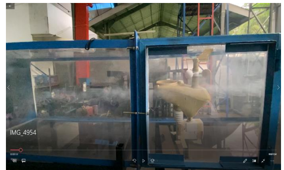
Gambar 23. Aliran Udara pada Benda Tampak Samping
