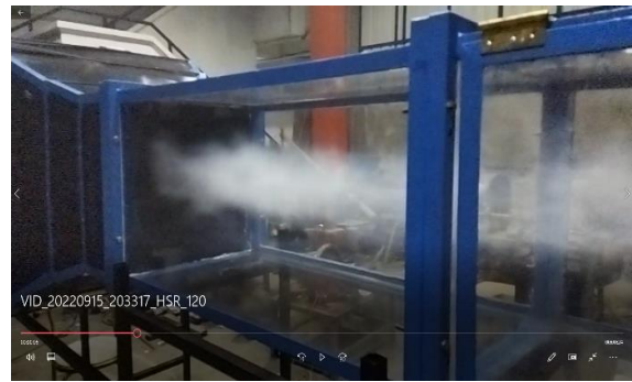
Gambar 22. Aliran Udara Visualisasi Asap
