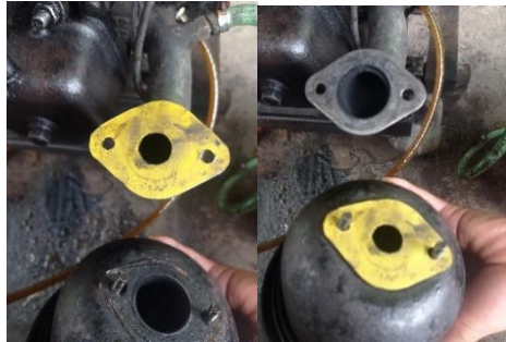
Gambar 3. Diameter lubang udara pada intake manifold
