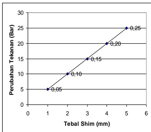
Gambar 14. Grafik Hubungan antara Tebal Shim dan Perubahan Tekanan
