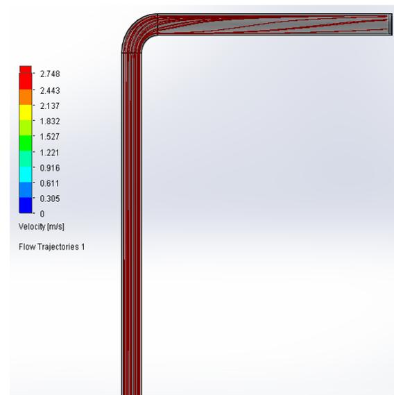
Gambar 5. Simulasi kecepatan fluida pada pipa hisap Ø 6 "
