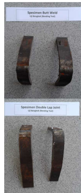
Gambar 10. Hasil pengujian lengkung ( bending ) sambungan las las Butt Weld dan Double Lap Joint
