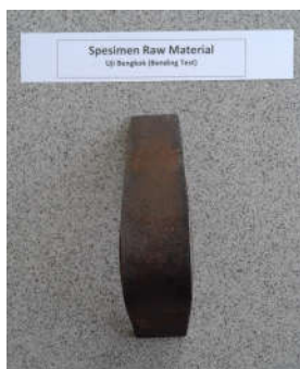
Gambar 11. Hasil pengujian lengkung ( bending ) pada raw material.
