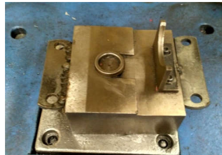
Gambar 5. Fixture proses flange install sebelum perbaikan.
