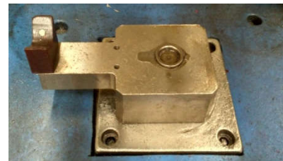
Gambar 6. Fixture proses sleeve install sebelum perbaikan.
