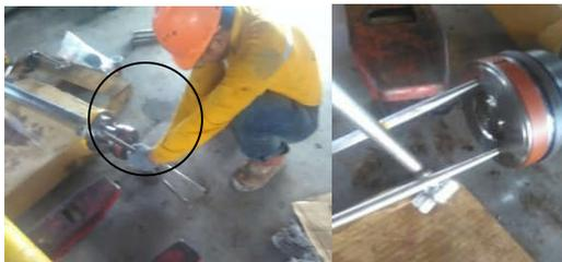
Gambar 4. Proses Pelepasan *Piston Steering Cylinder* secara manual
