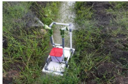
**Gambar 5.** Uji coba alat penyiram tanaman bawang merah
